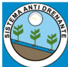
Mecanismo con una presión de cierre que bloquea el paso de agua, evitando el drenaje de las tuberías, dejándolas listas para el próximo riego
