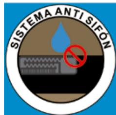
Mecanismo que bloquea la entrada de partículas al interior del gotero, evitando así taponamientos cuando la instalación es subterránea
