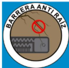
Ideal para riego subterráneo, evita la penetración de raíces dentro de los pasos de agua del gotero
